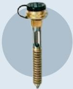
Dispositivo de alivio de presión diseñado tanto para abrirse como para cerrarse. Su función es permitir que el gas sea liberado al ambiente en caso de altas presiones evitando fallas mecánicas en el recipiente. Es importante no bloquearla con elementos que en su momento, impidan la apertura.
