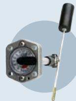
Permite determinar el volumen de GLP en estado líquido contenido en el tanque estacionario. La información se obtiene en porcentajes y en su llenado no puede exceder un nivel superior al 90%. Para recipientes con capacidad superior a 4.000 Gal. se utiliza el ROTOGATE como accesorio para medir el nivel del tanque.
