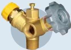
Acoplada directamente al tanque, permite el paso del GLP en estado gaseoso a los equipos de consumo. Esta acompañado de un dispositivo que permite determinar el máximo nivel de GLP líquido durante la operación de llenado.
